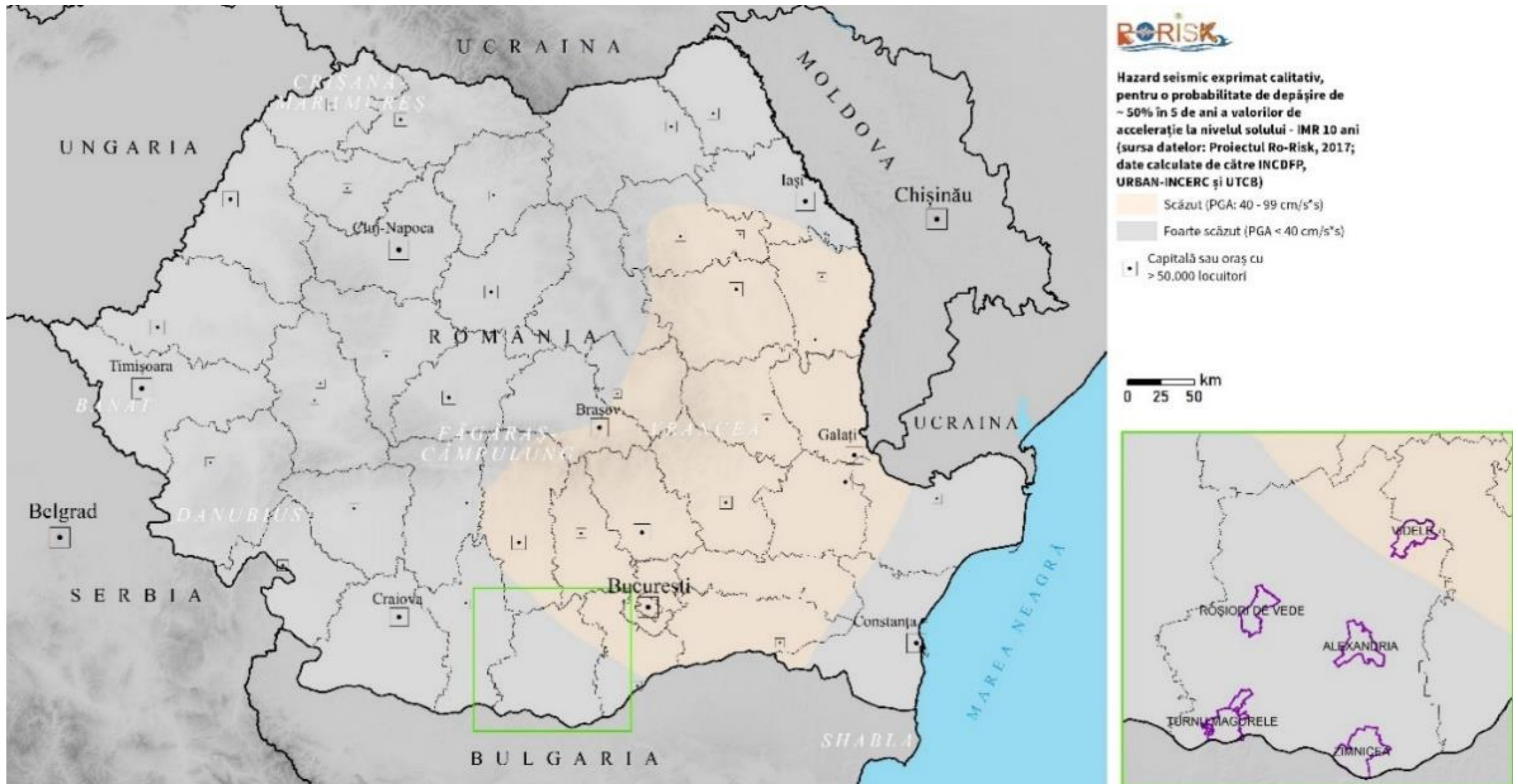
Fig. 121 Hazard seismic pentru IMR10 ani – harta generata pe baza datelor RO-RISK
